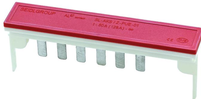
Universelles Hilfsmittel zur permanenten Überbrückung des SL-AKS/Z Anschlussystems. Die verpolungssichere und zukunftsorientierte Montage der SL-Überbrückung ermöglicht den provisorischen oder den Dauerbetrieb des Zähleranschlusses ohne Smartmeter / Energiezähler. Die Montage ist durch eine Elektrofachkraft durchzuführen.
